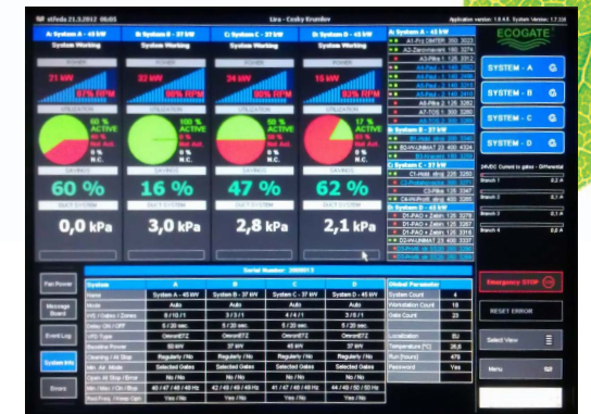
Okamžitý výkon motorů – Online sledování okamžitého výkonu jednotlivých motorů na display řídicího počítače.
